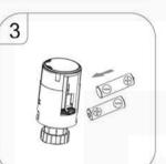
Remplacez les piles en suivant le schéma indiquant le sens de la polarité des piles.
