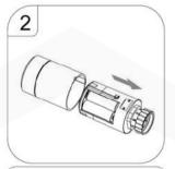
Retirez le noyau interne du boîtier dans le sens de l'écrou.
