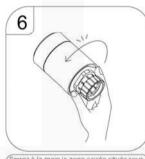
Serrez à la main la zone carrée située sous l'écrou. Tourner dans le sens inverse des aiguilles d'une montre avec un peu de force et bloquer le verrou après un "clic"
